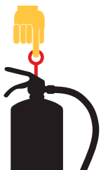
TRAGE ELEMENTUL DE SIGURANȚĂ
